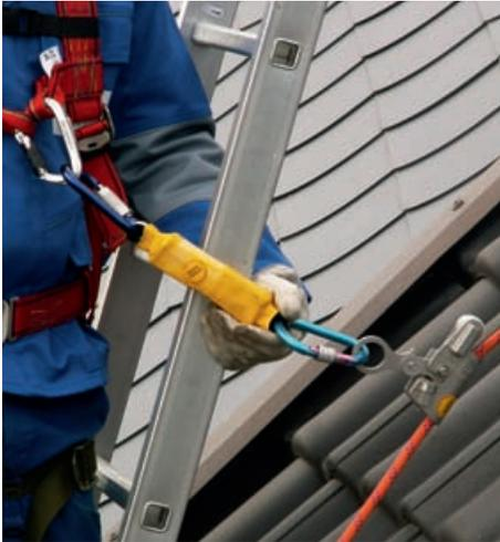
**Abb. 7.4.8:** Mitlaufendes Auffanggerät für an einer beweglichen Führung
